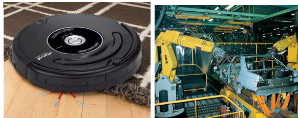
FIGURA 1. Esquerra: L'aspiradora ha estat dissenyada per poder superar petits obstacles però és fàcil bloquejar el seu recorregut amb una caixa. Dreta: En la cadena de muntatge, necessitem molts braços robot perquè cadascun faci una de les tasques del muntatge del cotxe.
